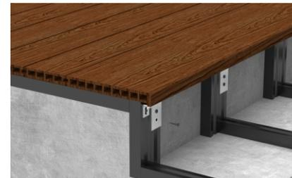
Рис. 22. Монтаж ступенчатого профиля
