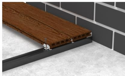
Рис. 15. Фиксация промежуточной доски клипсой
