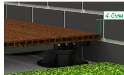
Рис. 18. Продольный зазор
