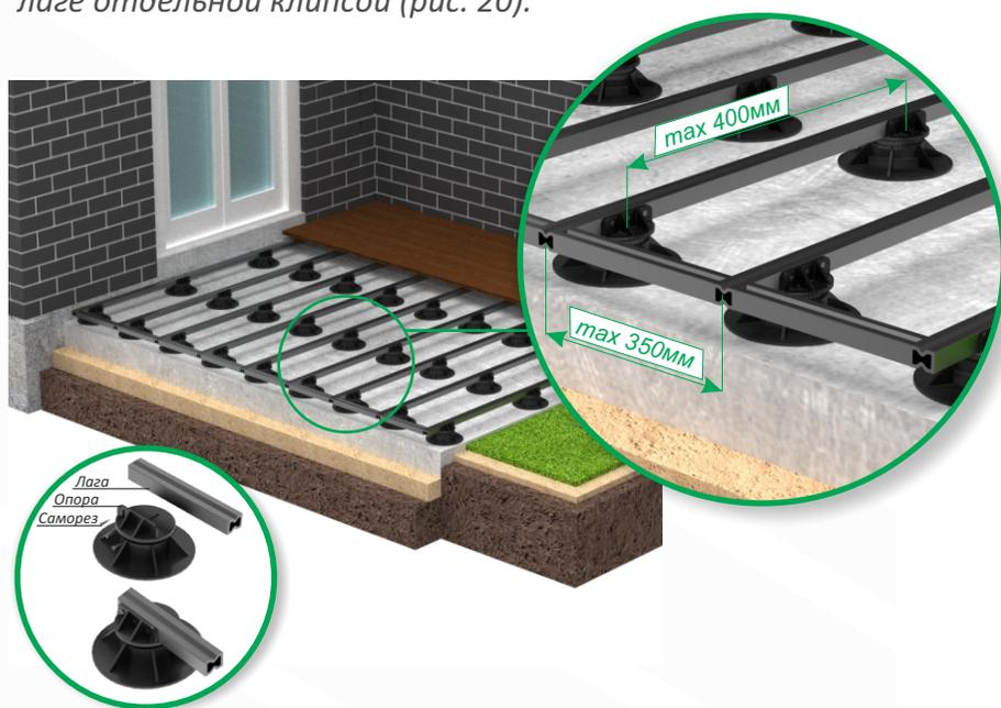
Рис. 8. Укладка лаг на опоры
